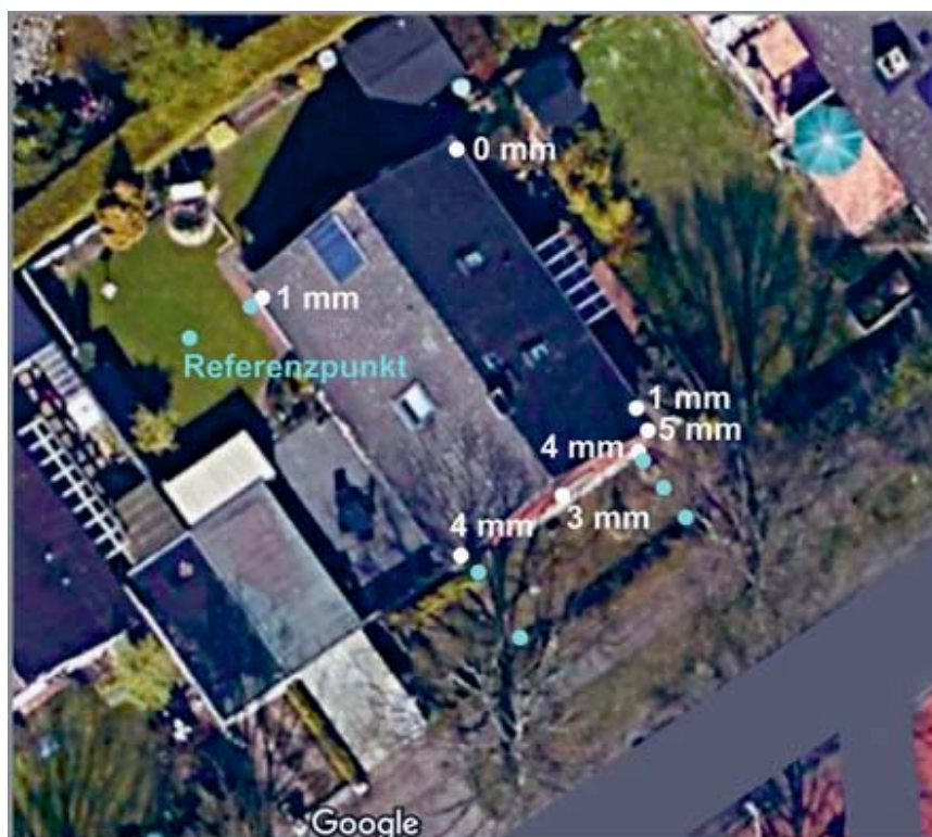
Abbildung 7: Zunahme des Gebäudeniveaus an den einzelnen Nivellierungspunkten während der Wintermonate im Zeitraum vom 26.11.2019 bis 06.04.2020 (weiß). Die Bohrpunkte zur Messung der Bodenfeuchte sind hellblau markiert. Der Referenzpunkt hatte einen größtmöglichen Abstand zu größeren Bäumen.
