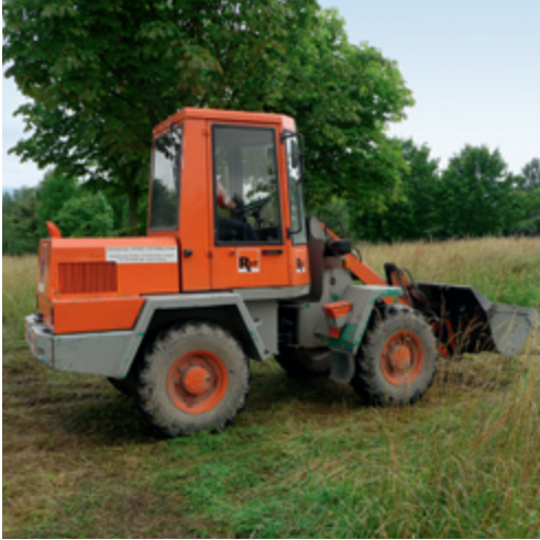
Abbildung 1: Bodenverdichtung mit einem Radlader
